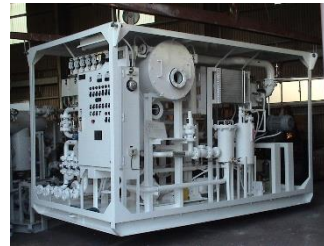
真空脱気装置(変圧器工場用)
