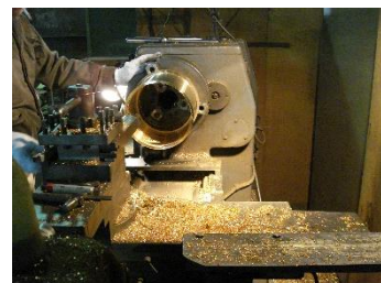
切削仕上げ工程
