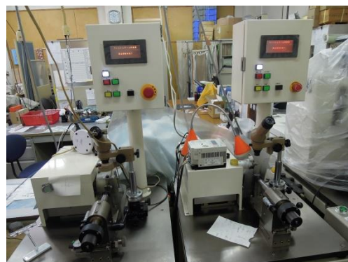
独自開発したプリント基板外形加工用ルーター・エンドミルの再研磨用装置
