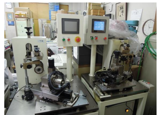
独自開発したプリント基板外形加工用ルーター・エンドミルの再研磨用装置
